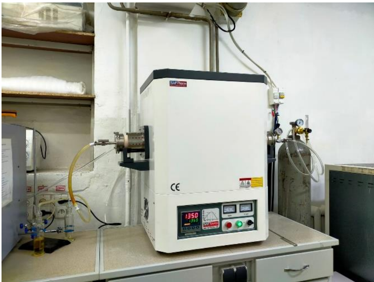
Рисунок 1. Высокотемпературная трубчатая вакуумная печь для синтеза МАХ фазы
